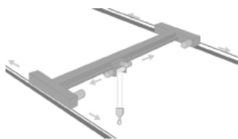
Pont monopoutre posé
